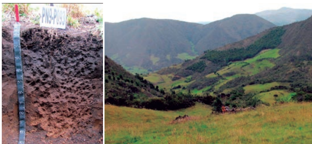
Figura 3.31. Perfil del suelo clasificado como Typic Hapludands (izquierda) ubicado en Pin Juma, Gima, Sigsig, Azuay sobre un relieve colinado alto en una pendiente > 70 % (derecha) (MIDENA, et al. , 2013u).
