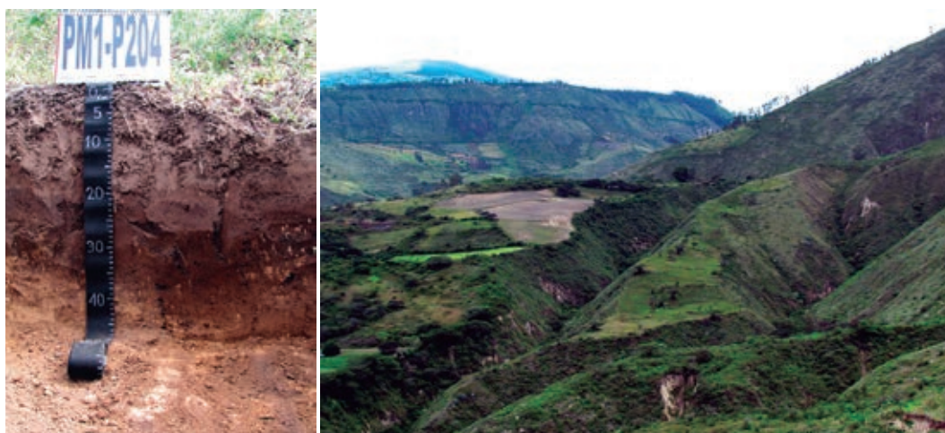
Figura 3.20. Perfil del suelo clasificado como Typic Durustolls (izquierda) localizado en Payama, García Moreno, Carchi, sobre un relieve volcánico colinado (derecha) (MIDENA, et al. , 2014a).
