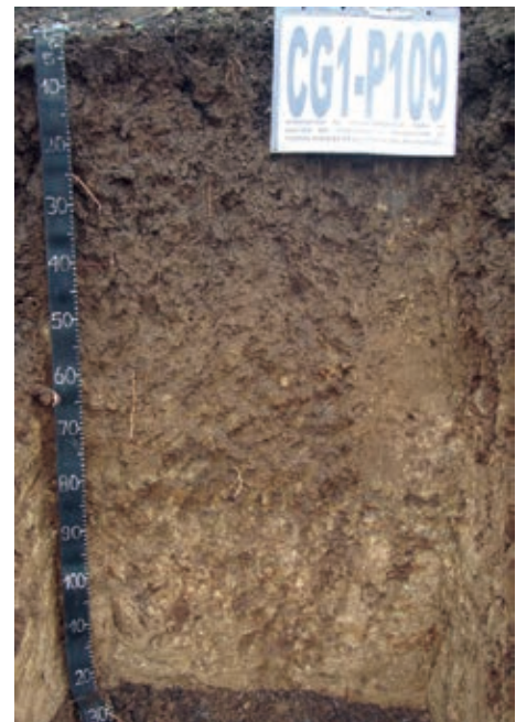
Figura 2.7. Perfil del suelo clasificado como Mollic Hapludalfs ubicado en El Cedro, Olmedo, Manabí, sobre la superficie disectada de una mesa de la formación Borbón (areniscas) en una pendiente < 25 % (CLIRSEN, et al. , 2010c).
