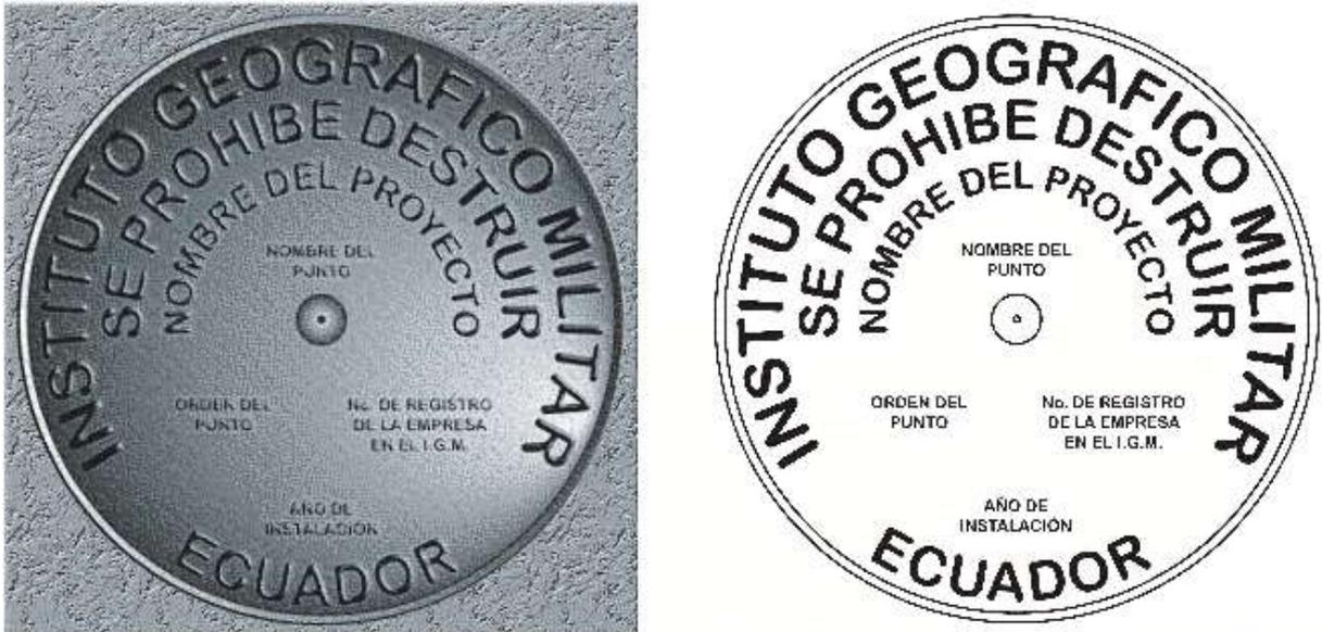
Fig. 01. Diseño de la inscripción en la placa de aluminio empleada para señalar el punto colocado
