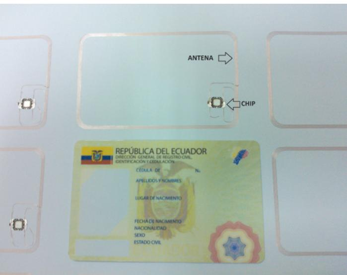
Figura 1. Inlay (Conjunto antena Chip)
