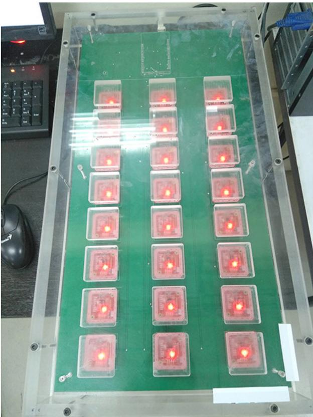
Figura 6. Equipo de verificación de Inlays construido.
