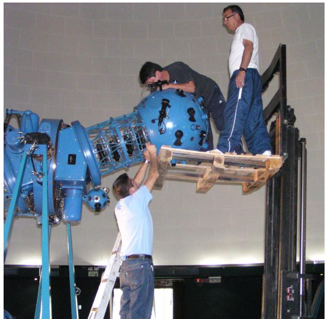
Figura 3. Labores de desmontaje del proyector optomecánico
