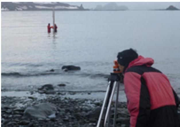
Figura 8. Nivelación geométrica
