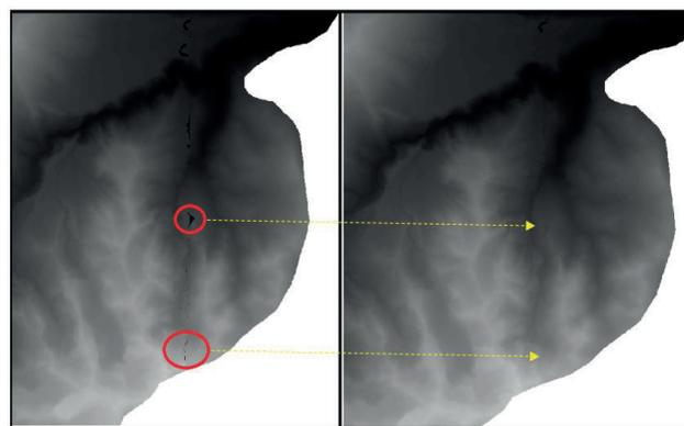
Figura 1. Relleno de vacíos y depresiones (Fill Sinks)
