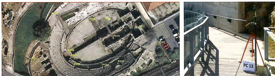
Figura 2. Trabajo fotogramétrico con Vehículos Aéreos no Tripulados. Fuente: Garfei-Aeroproducción, 2013.
