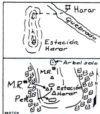
Figura 9. Descripción de una marca horizontal permanente.
