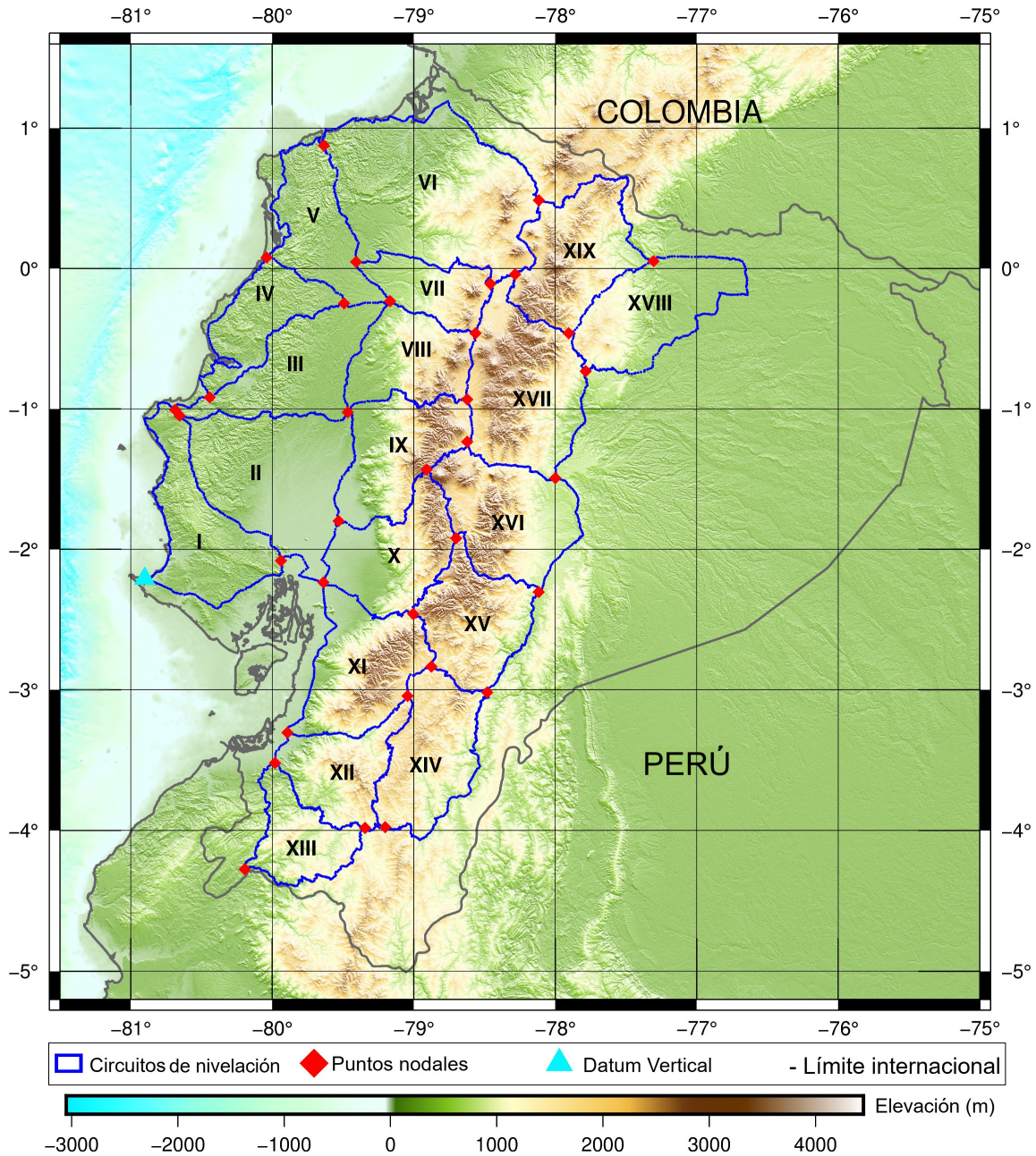
Ilustración 3: Red de Control Vertical de Ecuador
