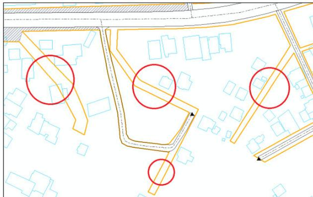
Omisión de ejes viales, no se observa el trazado (círculos en rojo)
