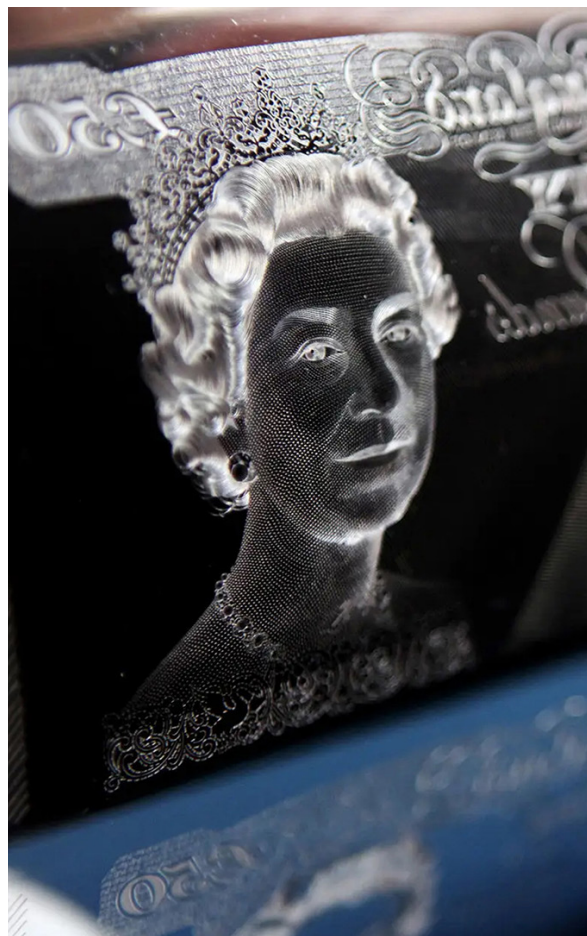
Figura 5. Retrato de la Reina Isabel grabado en una matriz para impresión calcográfica (billete de 50 libras).
