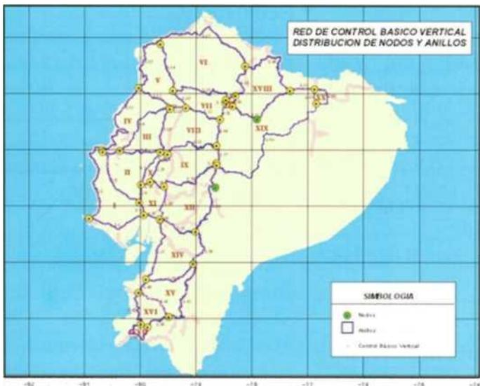
a vez definidos tanto los anillos como cada uno de los nodos; y chequeando los errores de cierre de cada circuito de nivelación, se procedió a obtener el desnivel y la distancia entre los nodos de la línea.
