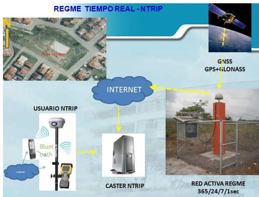
Figura No. 16: REGME - NTRIP, posicionamiento en tiempo real.
