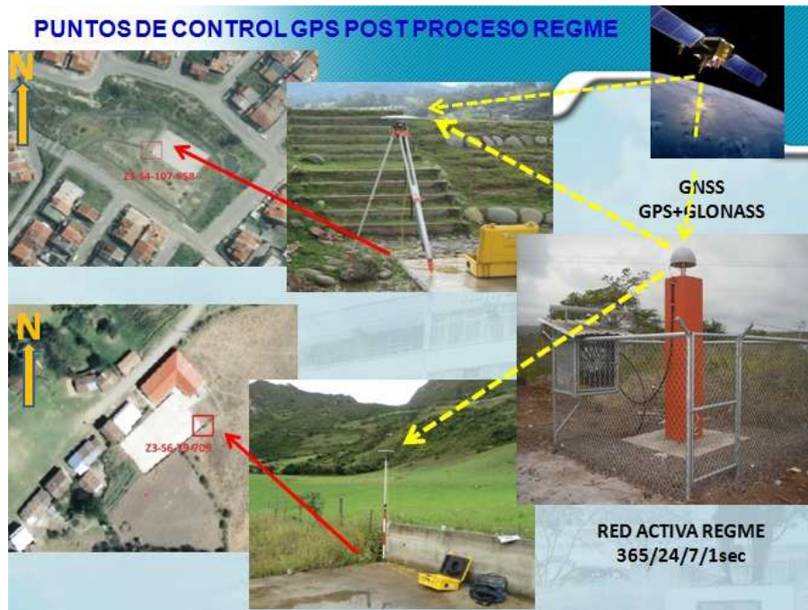
Figura No. 15: REGME, posicionamiento GNSS diferencial post proceso.
