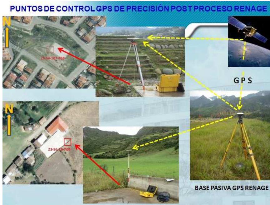
Figura No. 14: RENAGE, posicionamiento GPS diferencial post proceso.
