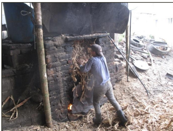
Foto 3.4.6. Utilización del bagazo como combustible para los hornos.
