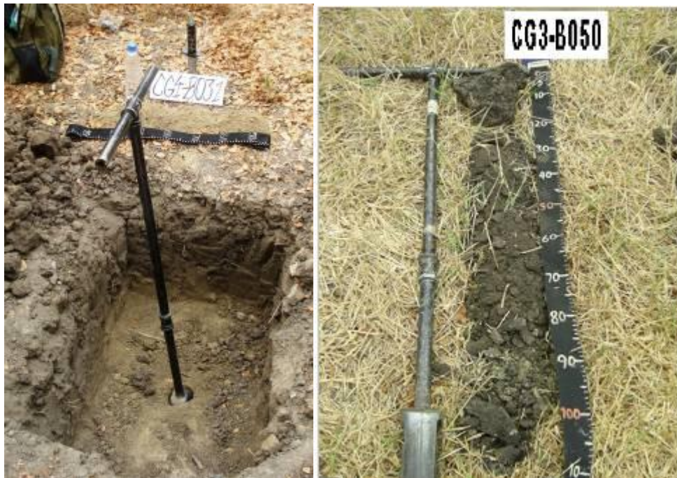
Figura 6.5c. Barrenaciones realizadas con el barreno tipo EDELMAN.
