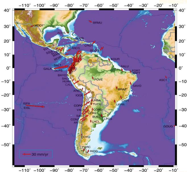
Figura No. 19: Campo de velocidad, estaciones permanentes SIRGAS\_CON e IGS. Fuente: Cisneros, D. and Nocquet, JM. (2011). CAMPO DE VELOCIDADES DEL ECUADOR, obtenido a través de Mediciones de Campañas GPS de los últimos 15 años y medidas de una Red GPS Permanente, IGM – IGEPN – GEOAZUR – IRD. Nice – France , 2011.
